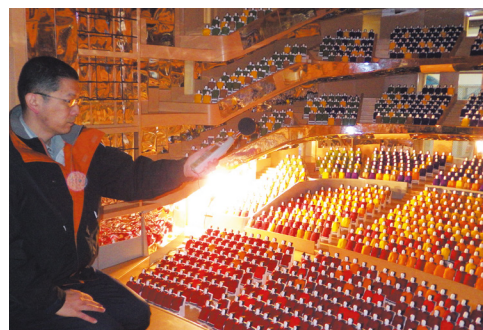
模型の中の客席に小さな人形を配置し、音の吸収まで忠実に再現した音響実験施設。
