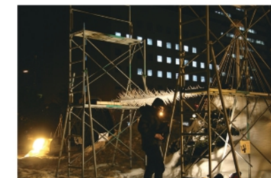
「回転式巨大つらら造形装置」2016年撮影 遠心力を利用し、噴霧された水滴が見たこともないの造形を作る。
